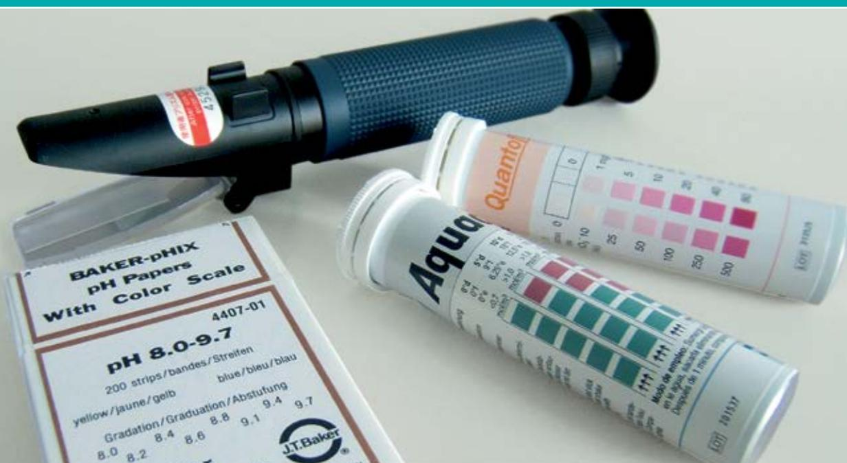
Рефрактометр для определения правильной концентрации.
