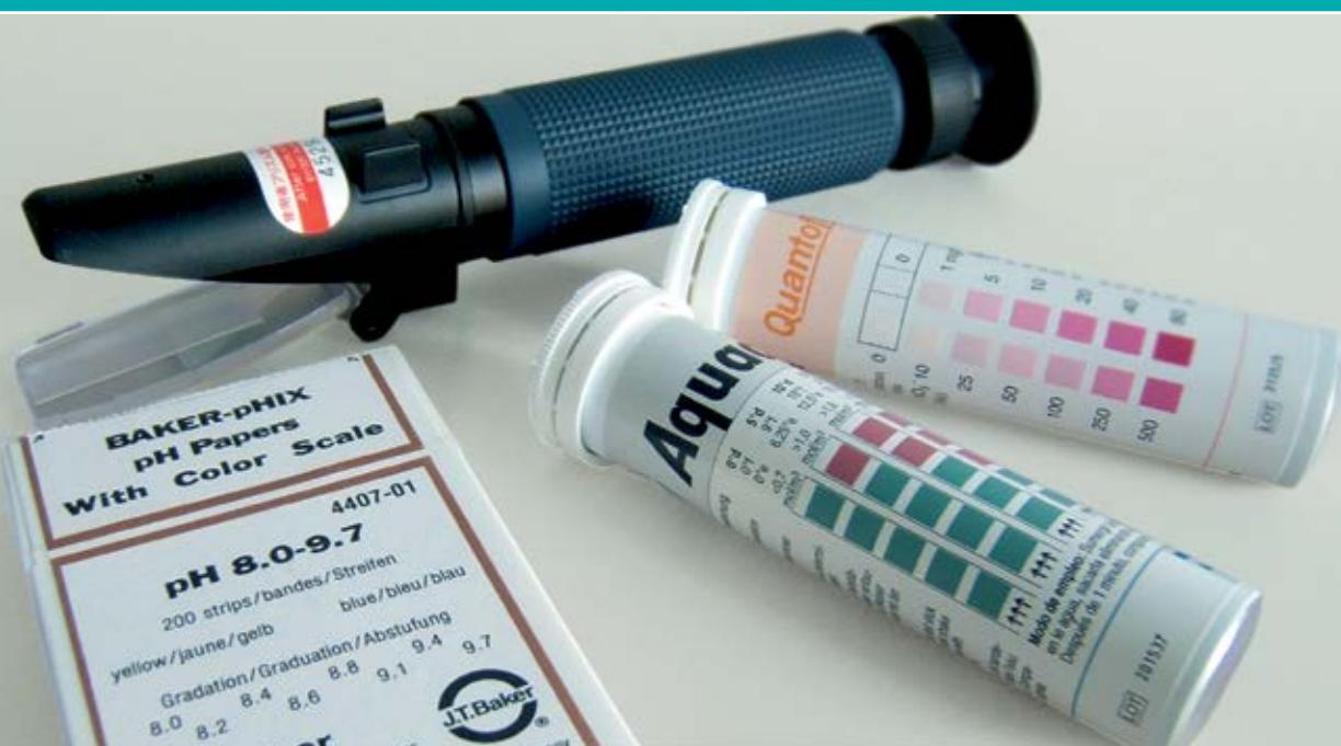
Рефрактометр для определения правильной концентрации.
